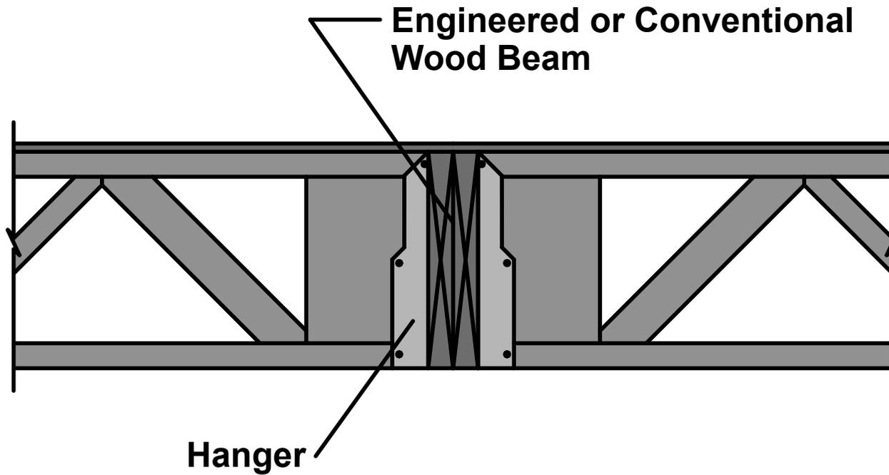
JOIST TO WOOD BEAM
